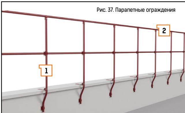
Углы соединения для труб ограждения позволяют замкнуть конструкцию в единый контур. Для простоты стыковки все трубы ограждения имеют обжим с одной стороны и легко вставляются одна в другую. Все детали ограждения оцинкованные, покрыты порошковой краской, устойчивой к атмосферным воздействиям.
