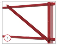
Горизонтальные трубы обжаты с одной стороны, для соединения в одну линию. Фиксания соелинения производится с помощью саморезов с прессшайбой.
