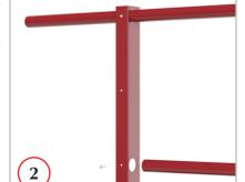
Укос крепится к стойке и трубе ограждения с помощью самореза с прессшайбой.
