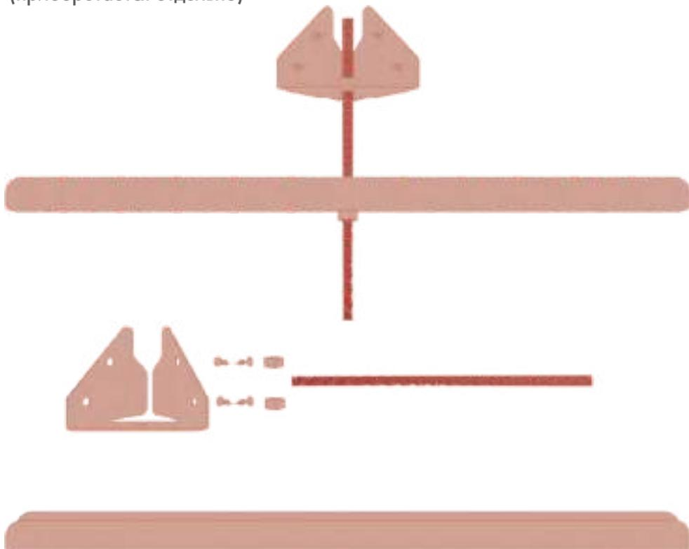
Рекомендуемый крепеж мин.  $\varnothing 5$  мм x 70мм
