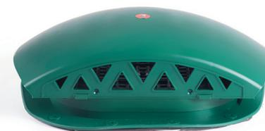
Обеспечивает доступ воздуха в подкровельное пространство, препятствует образованию конденсата и влаги в кровельных конструкциях и между кровельным покрытием и гидроизоляцией. Препятствует образованию плесени и грибка на стропильной системе и внутренней отделке дома.
